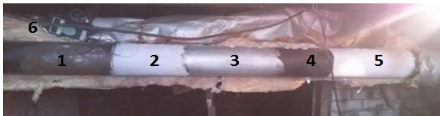
Рис. 4.19 Участки теплотрассы: 1 – резиновое покрытие, 2 – покрытие «Теплосил», 3 – резиновое покрытие с алюминиевой пудрой, 4 – непокрытый участок, 5 – покрытие «ReTherm», 6 – прибор ИТП-МГ4.03/Х(У) «ПОТОК» с тремя датчиками плотности тепловых потоков
