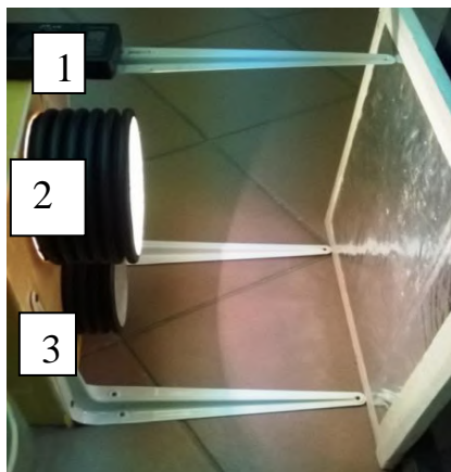
Рис. 4.21. Разработанный стенд по определению ИК-отражающей способности материалов на основе радиометра «Аргус-03»
