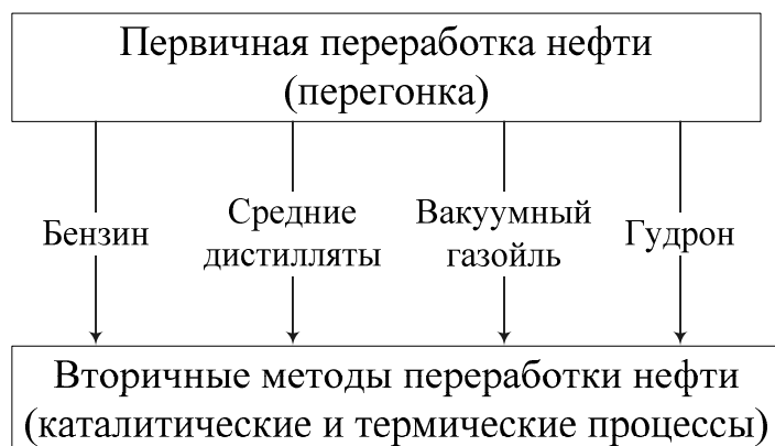
Рис. 16. Схема переработки нефти
