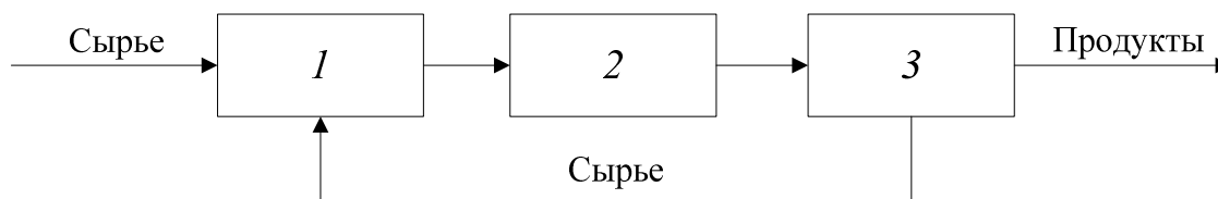
Рис. 42. Блок-схема реактора с рециклом сырья после разделения: 1 – смеситель; 2 – реактор; 3 – узел разделения
