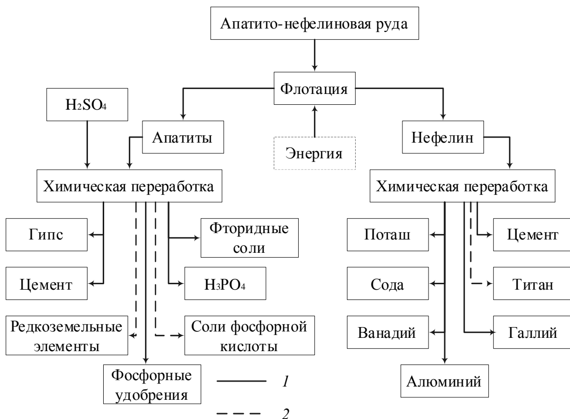
Рис. 15. Схема комплексного использования апатито-нефелиновой породы: 1 – процессы, осуществляемые в промышленности; 2 – потенциальные промышленные процессы
