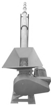
Рис. 2.8.37. Шнековый транспортер
