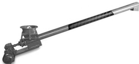
Рис. 2.8.35. Винтовой транспортер
