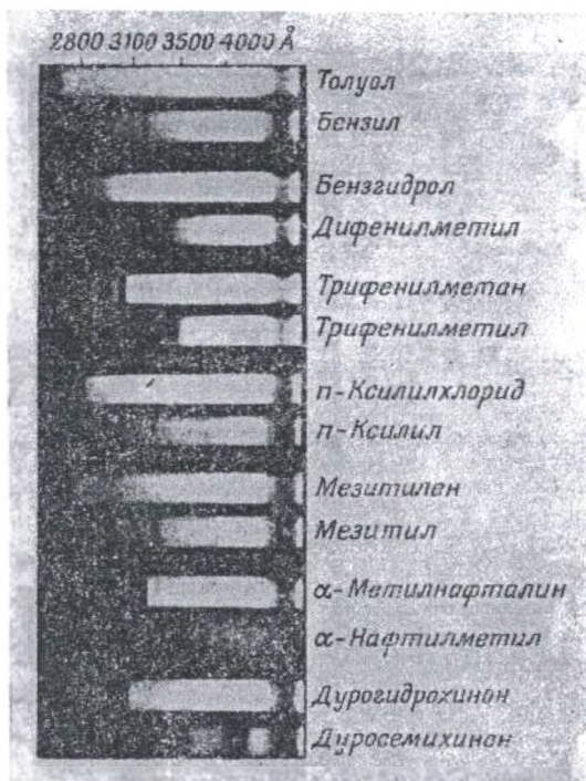
Рис. 28. Спектры радикалов, образующихся при фотолизе ароматических соединений при 80° K [177].
