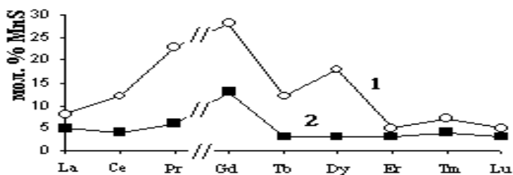
Рис. 5.19. Зависимости протяженности твердых растворов в системах \text{MnS} - \text{Ln}_2\text{S}_3 ( \text{La} = \text{La} - \text{Lu} ) при T=1570 К (1) и T=1170 К (2): а — на основе \text{MnS} ; б — на основе \text{Ln}_2\text{S}_3
