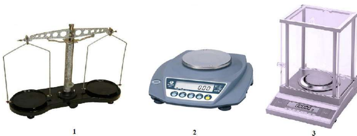
Рис. 17. Весы 1 – технические, 2, 3 – аналитические
