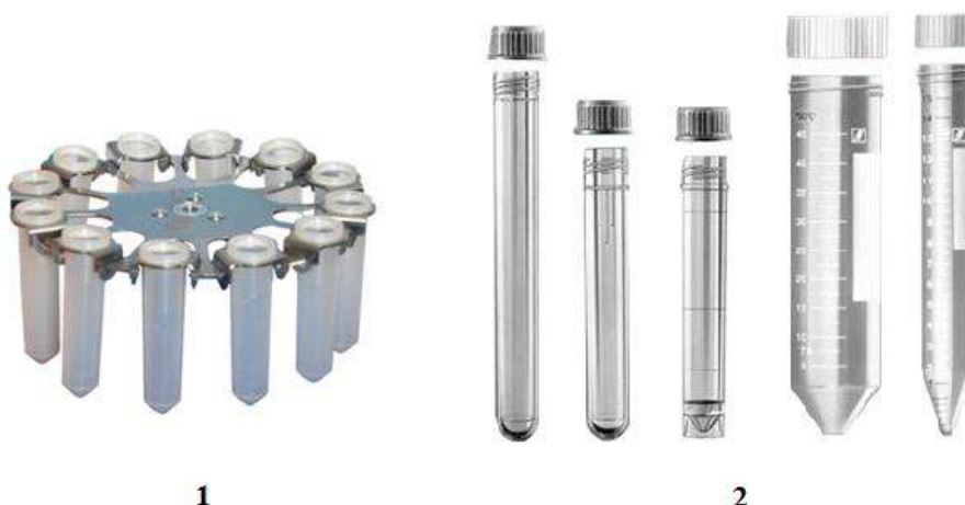
Рис. 16. Гильзы ( 1 ) и приборки ( 2 ) для центрифугирования
