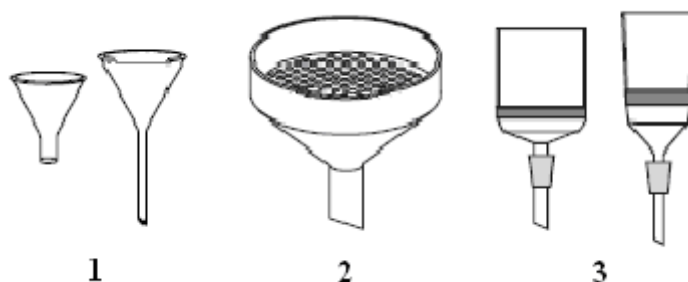
Рис. 3. Химические воронки: 1 – коническая; 2 – Бюхнера; 3 – Шотта
