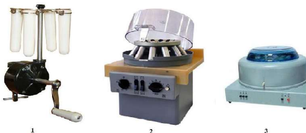
Рис. 15. Центрифуги: 1 – с ручным и 2 – механическим приводом; 3 – автоматическая
