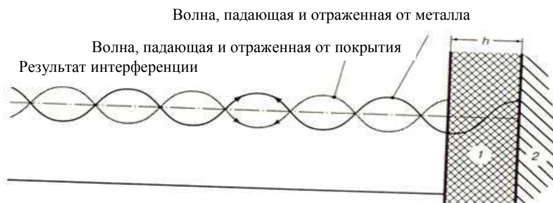
Рис. 2.6. Принцип работы интерференционных узкодиапазонных материалов: 1 – покрытие; 2 – металл
