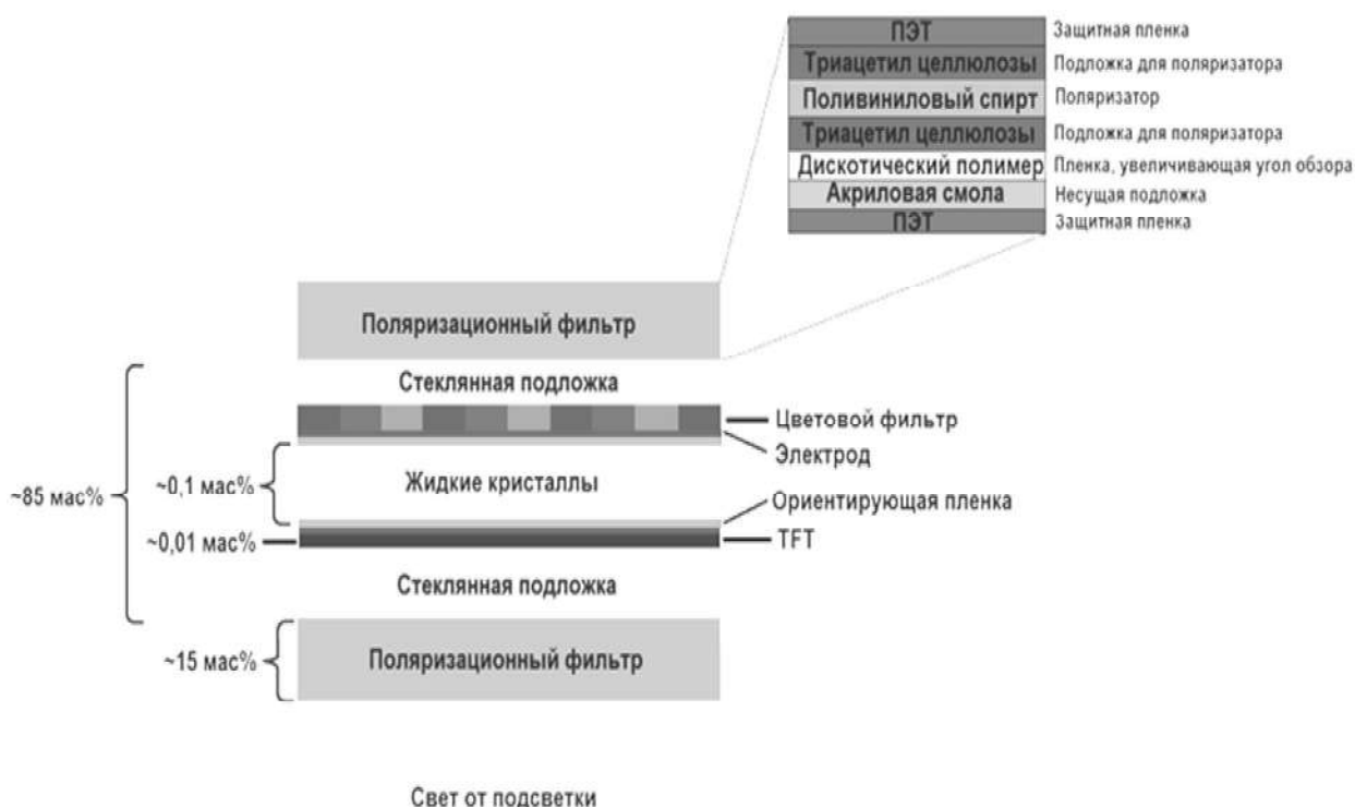
Рис.1.24. Виды ЖК мониторов и их составные слои
