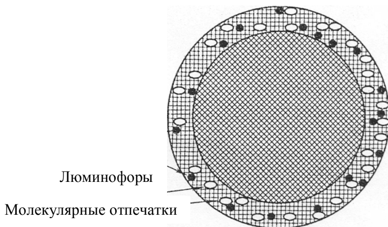
Рис.1.35. Строение сшитой полимерной частицы типа ядро – оболочка с молекулярными отпечатками органических соединений и ковалентно связанными люминофорами в оболочке
