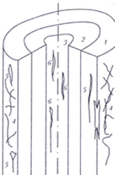
Рис. 2.7. Схематическая структура стеклянного алюмоборосиликатного волокна (филамента) фильерной вытяжки
