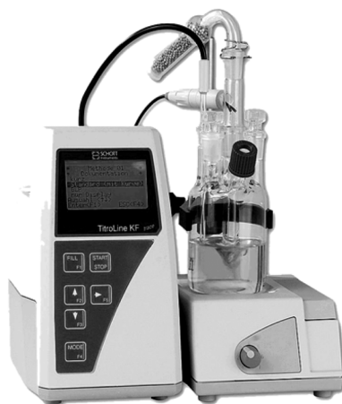
Рис. 31. Общий вид автоматического титратора по методу К. Фишера
