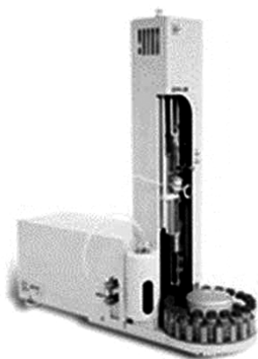
Рис. 41. Общий вид автоматического дозатора жидких проб
