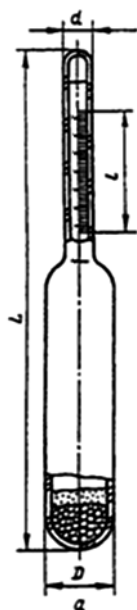
Рис. 25. Ареометр для определения плотности жидких продуктов
