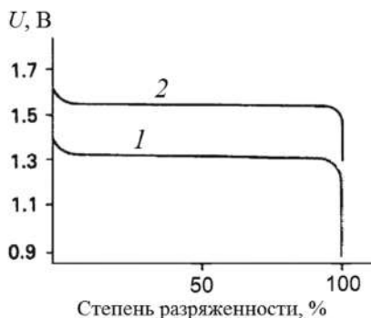
Рис. 2.7. Кривые разряда ртутно-цинкового (1) и серебряно-цинкового (2) первичных элементов
