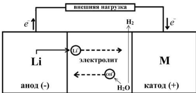
Рис. 2.8. Схема литиевого гальванического элемента с водным электролитом
