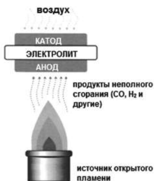
Рис. 4.14. Схематическое изображение бескамерного твердооксидного топливного элемента
