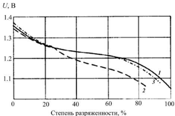
Рис. 3.4. Влияние "эффекта памяти" на кривую разряда никель-кадмиевого аккумулятора: 1 – исходная кривая; 2 – после циклирования с малой глубиной разряда; 3 – после восстановительных циклов
