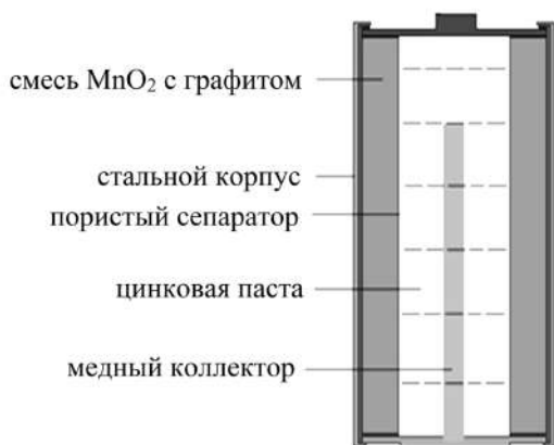
Рис. 2.4. Схема щелочного марганцево-цинкового элемента
