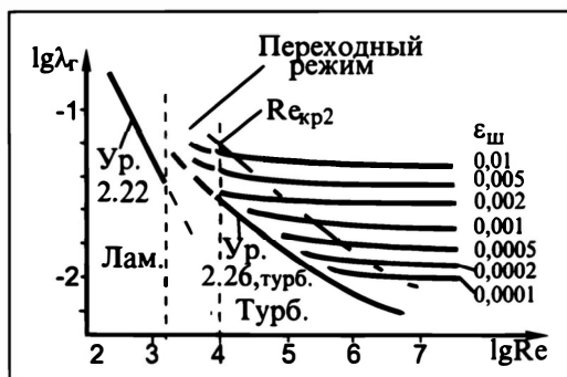
Рис.2.15. Общий график зависимости \lambda_r от Re при различных относительных шероховатостях \epsilon_{ш}
