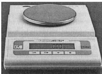
Рис. 2.1. Технические весы с пределами взвешивания от 0,1 г до 3 кг
