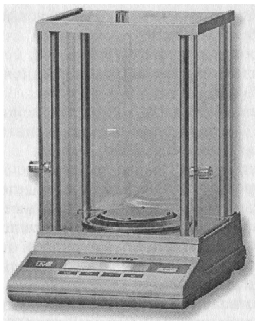
Рис. 2.2. Аналитические весы со встроенным интерфейсом RS232C для подключения к персональному компьютеру
