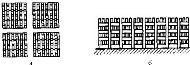
Рис. 1.45. Схемы садок на вагонетку туннельной печи: а – штабельная (вид сверху); б – столбиковая (вид с торца вагонетки)
