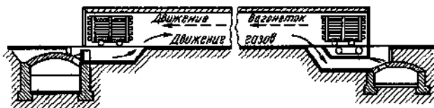
Рис. 1.52. Туннельное сушило со сосредоточенным подводом и отводом сушильного агента
