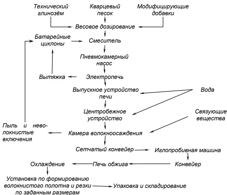
Рис. 5.7 Принципиальная схема получения алюмосиликатного волокна центробежным методом
