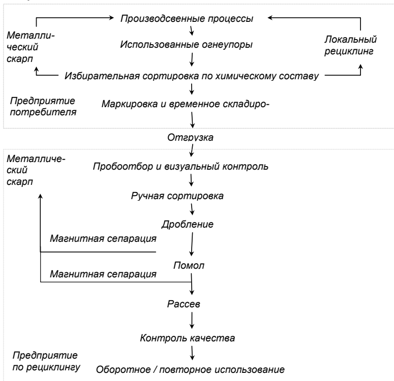
Рис. 7.1 Схема типичного процесса рециклинга
