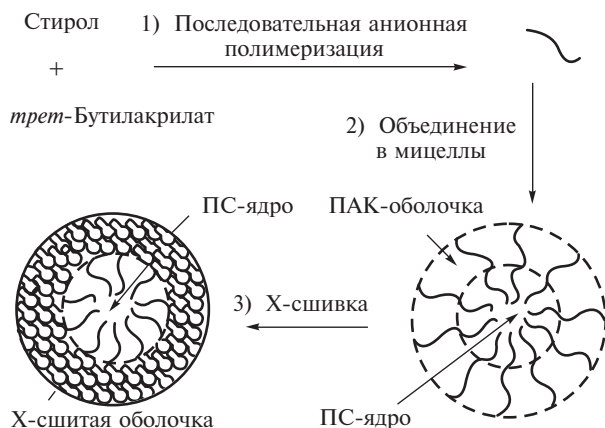
Рис. 4.7. Трехступенчатый синтез блок-сополимера со сшитой структурой: 1 — образование амфифильного блок-сополимера ПС-блок-ПАК, 2 — самосборка блок-сополимера в полимерную мицеллу, 3 — сшивка гидрофильных сегментов оболочного слоя
