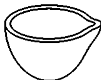
Рис. 21.14. Фарфоровая ступка (а) с пестиком (б)
