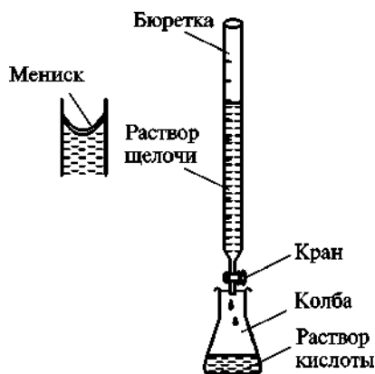
Рис. Л.3.2. Титрование раствора кислоты стандартным раствором щелочи
