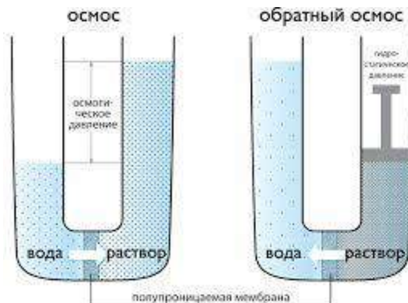
Рис. 3. Схема осмотического и обратного осмотического процессов (источник: http://strport.ru )
