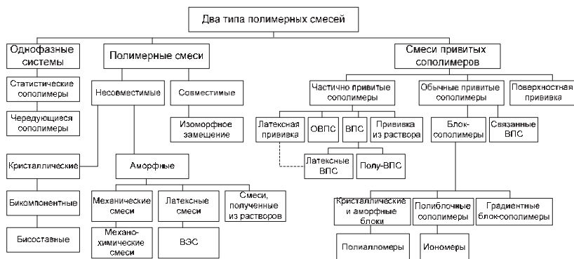
Рисунок 19. Схема классификации полимерных смесей
