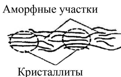
Рис. 2. Расположение кристаллитов и аморфных участков полимеров
