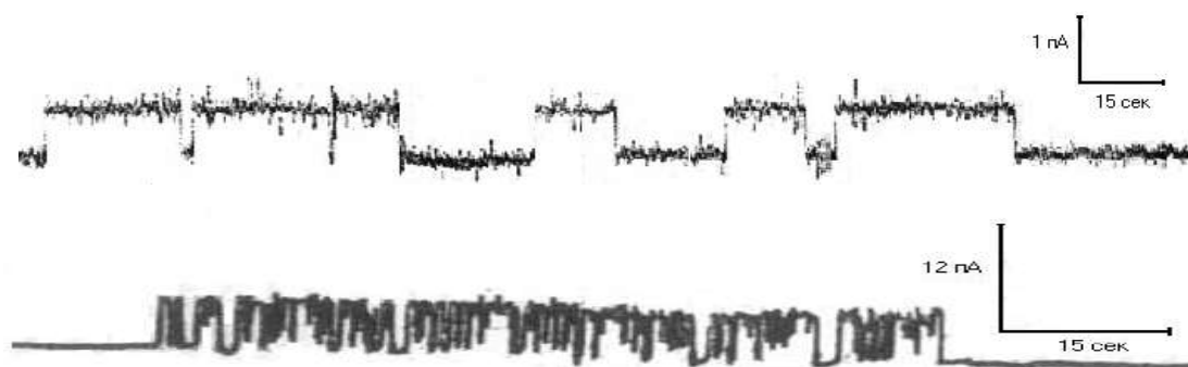
Рис.52. Регистрация токов одиночных ионных каналов, обладающих различными проводимостями. Условия экспериментов: 1 \mu M краун-эфира 56 (сим), 100 mM KCl, 25 mM Трис-HCl, pH-7,4, U_{\text{фикс}} +40 мВ.
