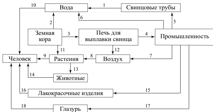
Рис. 2.9. Схема перемещения свинца и его соединений в окружающей среде: 1 — загрязнение свинцом воды, проходящей по трубам; 2 — вымывание свинца из пород и руд; 3 — рудоперерабатывающие процессы; 4 — получение чушкового свинца; 5 — прокат труб; 6 — сточные воды; 7 — выбросы в атмосферу; 8 — адсорбция свинца растениями из загрязненной атмосферы; 9 — употребление человеком загрязненной сельхозпродукции; 10 — использование загрязненной питьевой воды; 11 — попадание свинца в растения через корневую систему; 12 — выбросы в атмосферу при выплавке; 13 — поедание загрязненных растений животными; 14 — употребление человеком мяса животных; 15 — изготовление свинецсодержащих красок; 16 — попадание свинца с красками в организм человека; 17 — покрытие посуды свинцовой глазурью; 18 — попадание свинца в пищу из глазурованной посуды
