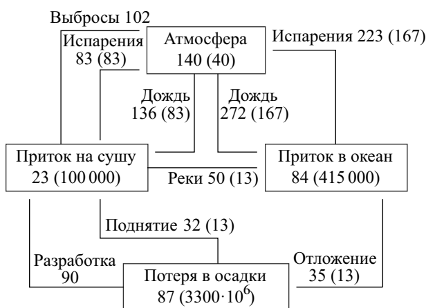
Рис. 1.9. Схема круговорота ртути [Wollast et al, 1975]. Запасы выражены в сотнях тонн, перемещения — в сотнях тонн в год. В скобках указана природная составляющая, вне скобок — антропогенная
