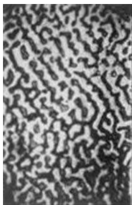
Рис. 4.7 Самоорганизация при облучении лазером сплава Fe-Cr-Ni
