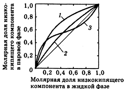
Рис. 52. Состав жидкой и паровой фазы бинарной смеси:
