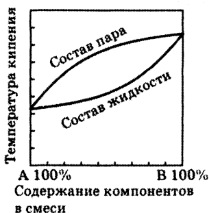
Рис. 53. Кривая равновесных состояний системы «жидкость — пар»
