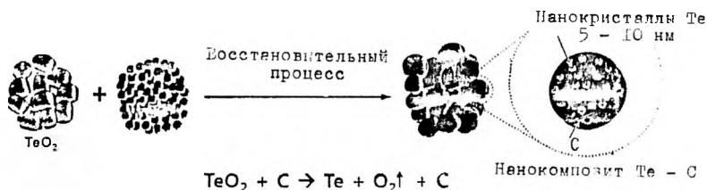
Рис. 7.9. Схема получения нанокompозита Te-C путём восстановления оксида теллура(IV) углеродом по данным работы [145]
