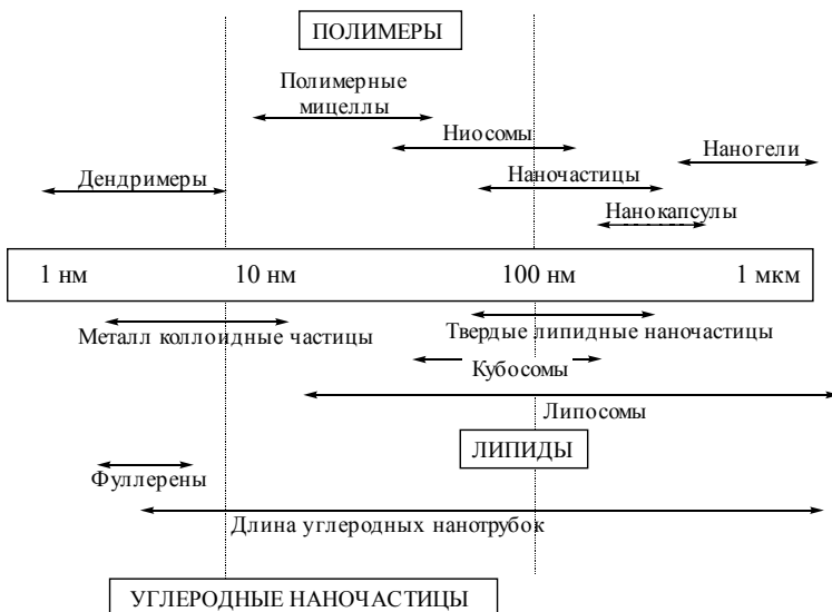
Рис. 3.7. Тип и размер частиц, используемых для доставки лекарственных препаратов [3.45]
