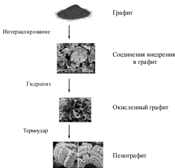
Рис. 2.33. Основные стадии получения окисленного графита и пенографита
