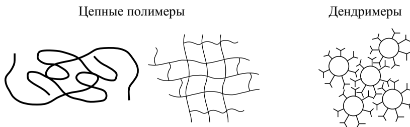
Рис. 2.11. Схема образования межмолекулярной сетки [2.68]
