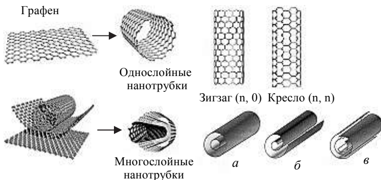
Рис. 2.36. Образование однослойных и многослойных структур углеродных нанотрубок, примеры изменения симметрии свернутой графитовой плоскости нанотрубок и структурные типы многослойных нанотрубок
