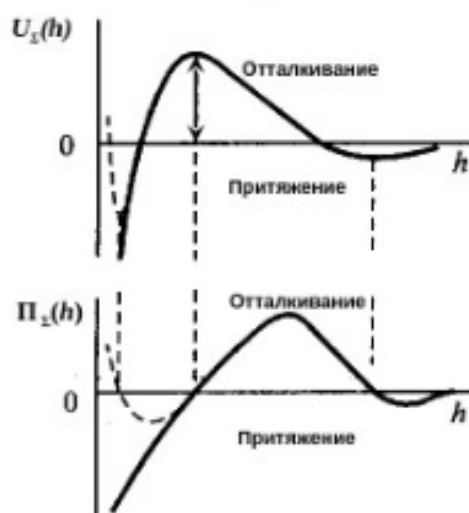
Рис. 50. График зависимости расклинивающего давления от расстояния между пластинами
