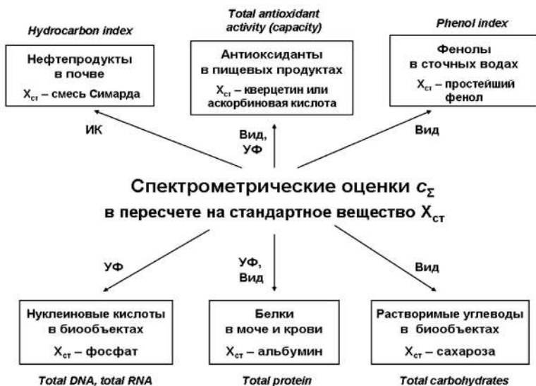
Рис. 1.3. Примеры интегральных показателей, определяемых спектрометрическим методом в УФ-, ИК- и видимой (Вид) областях спектра
