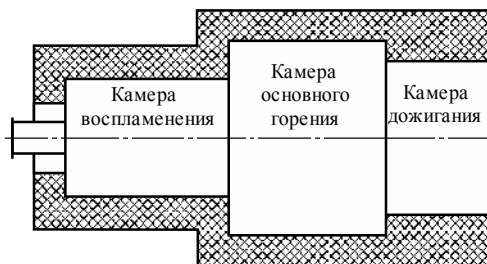
Рис. 6.14. Структура циклонного предтопка
