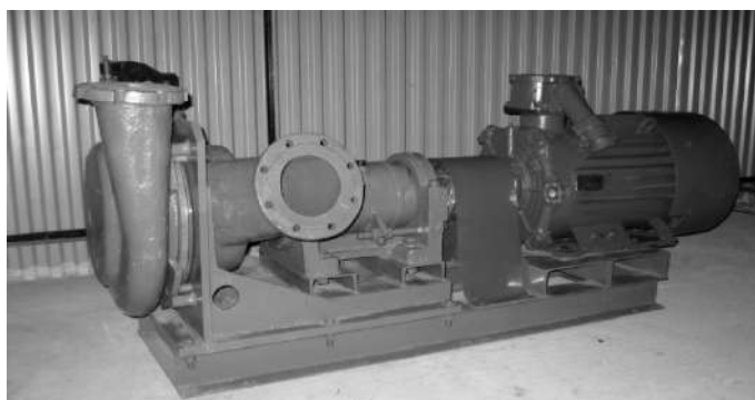
Рис. 2.29. Промышленный кавитатор производительностью 40 т/ч ИКЖТ
