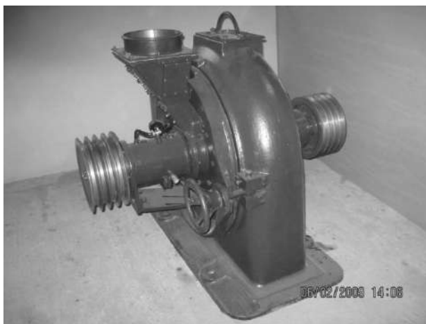
Рис. 2.8. Дезинтегратор производительностью 3 т/ч
