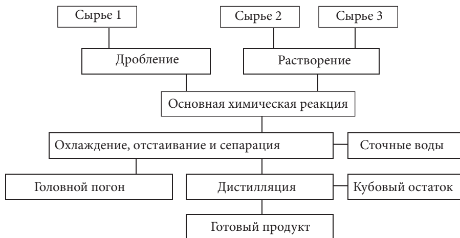
Рис. 1.3. Схема-граф материальных потоков химического производства
