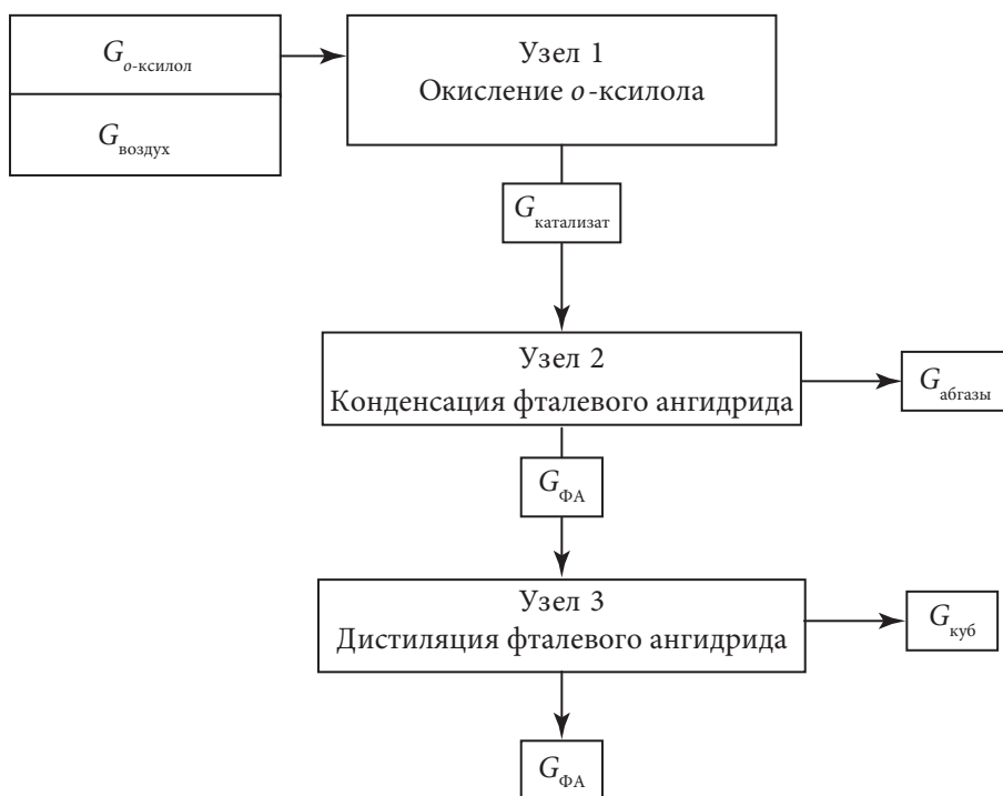
Рис. 1.7. Схема-граф материальных потоков производства фталевого ангидрида
