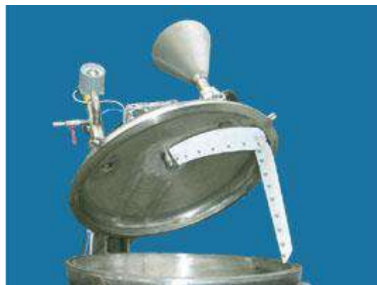
Рис. 25. Внутренний вид вакуумного миксера-гомогенизатора типа УМТИ-СИ
