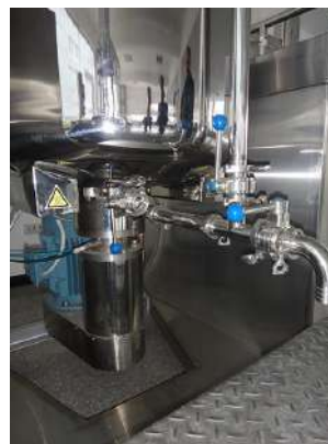
Рис. 31. Внешний и внутренний виды смесителя-гомогенизатора EMULSIFIER СРК
