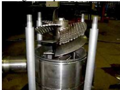
Рис. 9. Гомогенизатор-диспергатор РПГ-7,5 Gidromix, двухступенчатый
