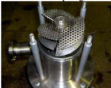
Рис. 9. Гомогенизатор-диспергатор РПГ-7,5 Gidromix, двухступенчатый
