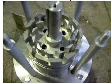
Рис. 9. Гомогенизатор-диспергатор РПГ-7,5 Gidromix, двухступенчатый
