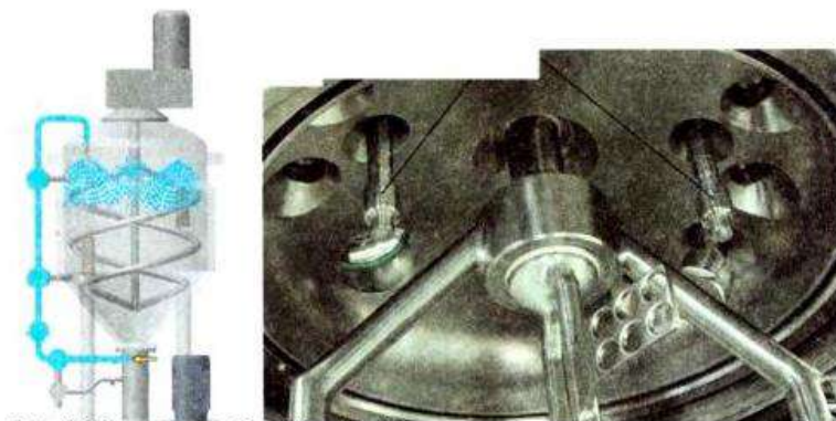
Рис. 50. SIP-форсунки для безразборной мойки аппарата на месте
