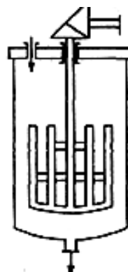
Рис. 79. Аппарат с рамной мешалкой
