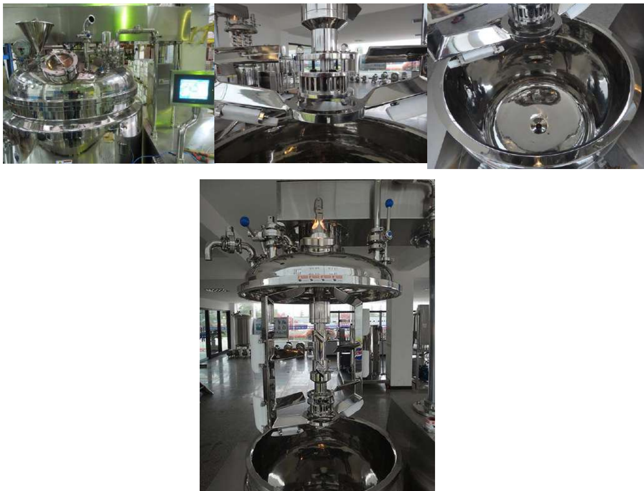
Рис. 32. Внешний и внутренний виды смесителя-гомогенизатора EMULSIFIER PPK
