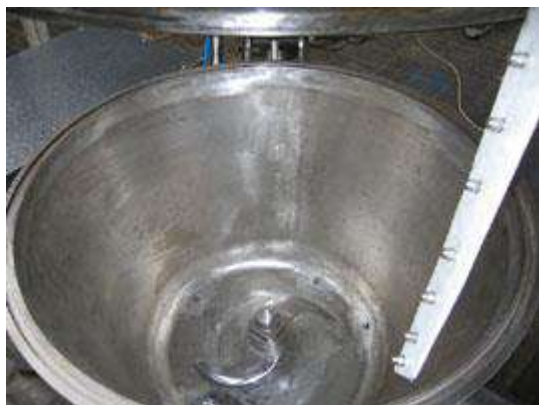
Рис. 25. Внутренний вид вакуумного миксера-гомогенизатора типа УМТИ-СИ
