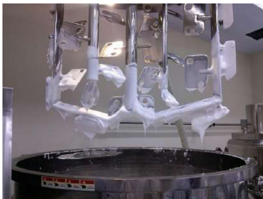
Рис. 31. Внешний и внутренний виды смесителя-гомогенизатора EMULSIFIER СРК
