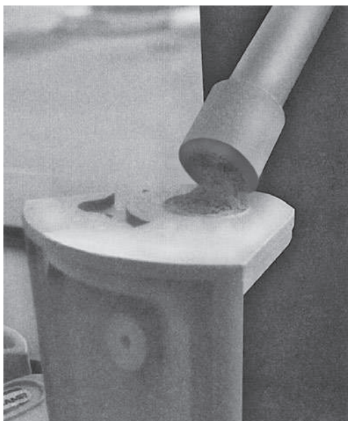
Рис. 15.15. Разрушение детали из-за чрезмерного перепада толщины стенки
