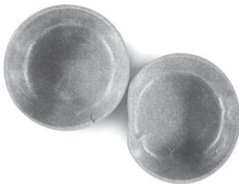
Рис. 15.6. Пример разрушения, обусловленного неправильным выбором материала, сделанным на основании кратковременных испытаний
