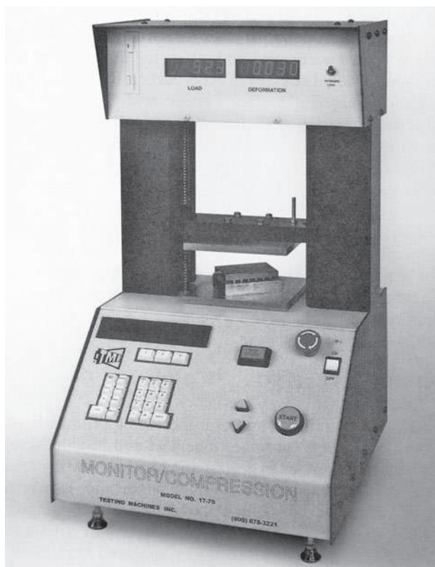
Рис. 12.11. Прибор для испытаний на сжатие — «краш-тестер» (с разрешения Testing Machines, Inc. )
