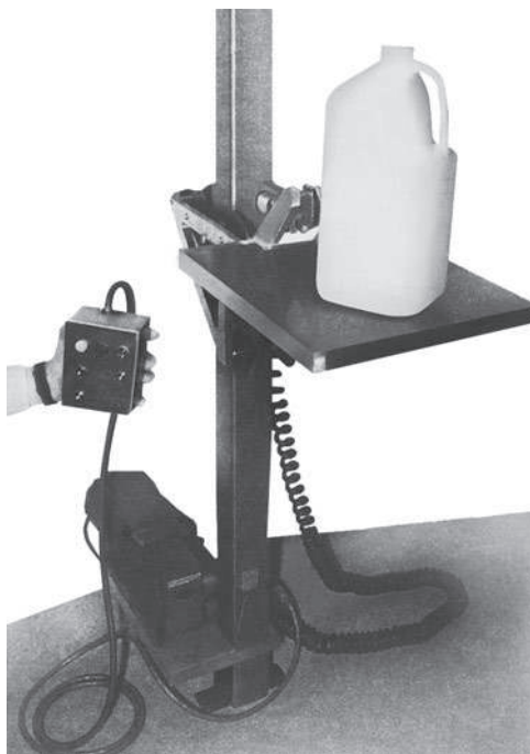
Рис. 2.53. Установка для испытания контейнеров методом падения на твердую поверхность
