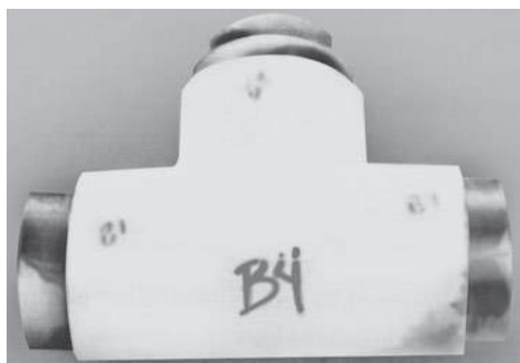
Рис. 15.7.2. Усталостное разрушение тройника под действием циклических ударов воды при разбрызгивании струи
