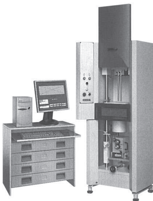
Рис. 1.3. Двухцилиндровый капиллярный реометр (с разрешения CEAST USA )
