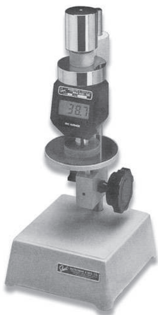
Рис. 2.62. Тестер для измерения твердости по Барколю (с разрешения Instron Corporation )
