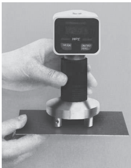
Рис. 2.63. Дюрометр для измерения твердости (с разрешения Qualitest, USA )
