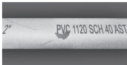
Рис. 15.4.3. Разрушенная труба из ПВХ
