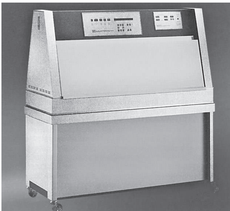
Рис. 5.1. Аппаратура для создания ультрафиолетового излучения и конденсации влаги (с разрешения Q-Panel Lab Products)
