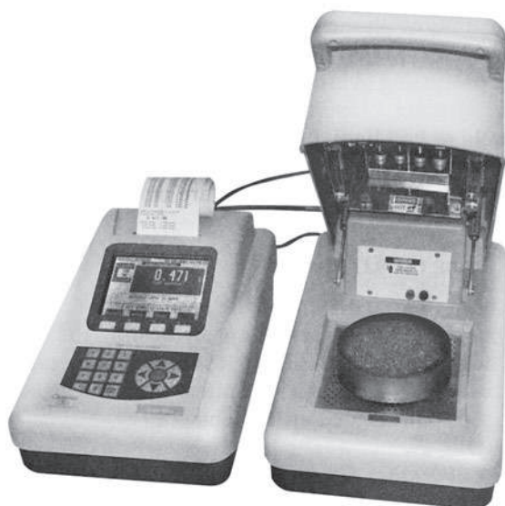
Рис. 10.3. Анализатор влажности, в котором реализован метод LOD (с разрешения Omnimark Instrument Corporation )
