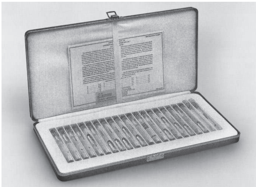
Рис. 7.30. Пузырьковый вискозиметр (с разрешения Вук-Gardner USA )
