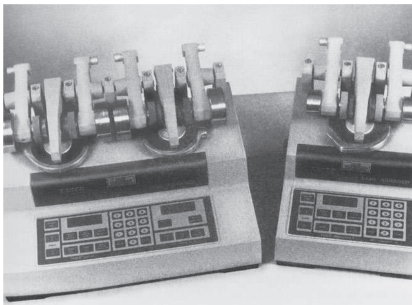
Рис. 2.55. Тестер для испытаний на износ (с разрешения Taber Instruments )
