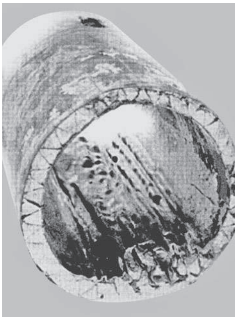
Рис. 15.7.1. Сечение разрушенной трубы, изготовленной из АБС-пластика, которое произошло вследствие длительного воздействия растворителей в чистящем составе
