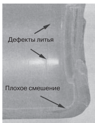
Рис. 15.6.4. Дефекты процесса литья — рябь на поверхности и плохое смешение
