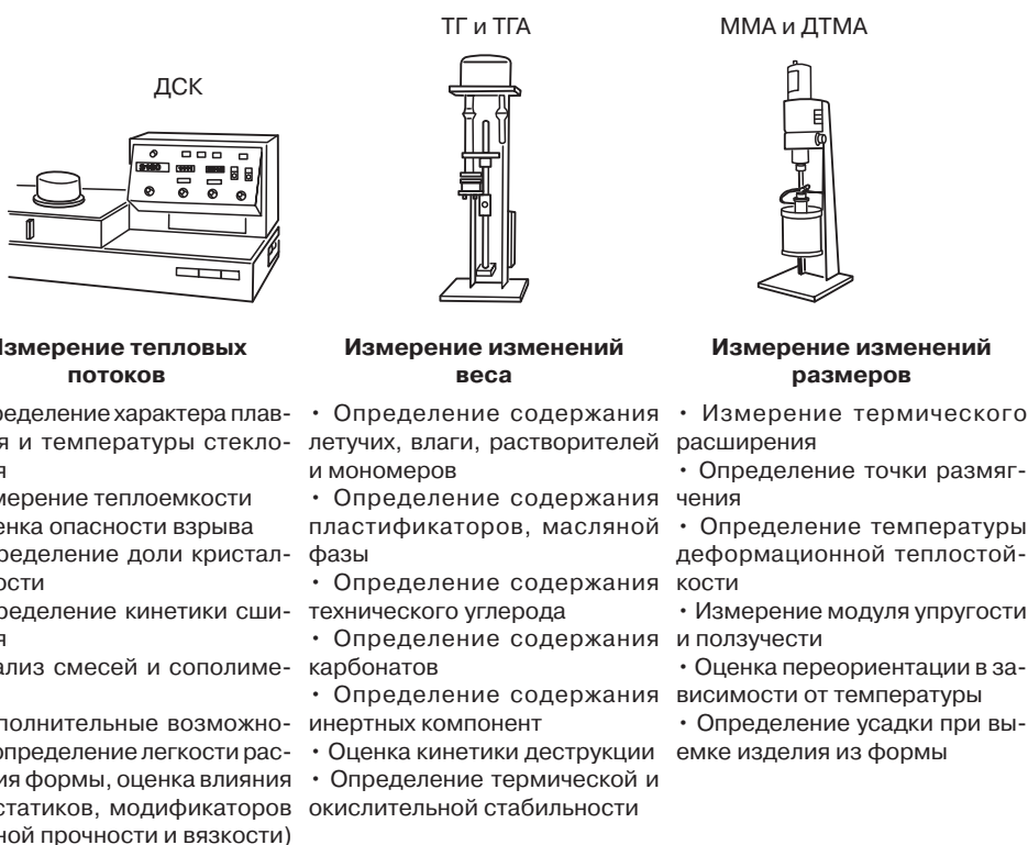
Рис. 7.15. Термический анализ пластмасс (с разрешения Perkin-Elmer Corporation )
