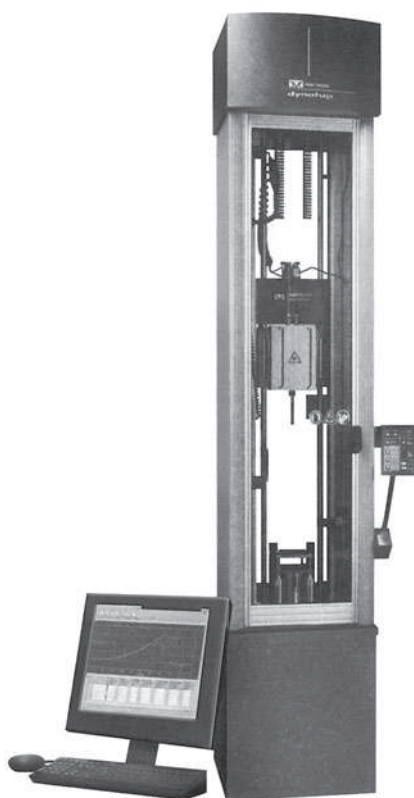
Рис. 2.51. Инструментальный тестер для ударных испытаний (с разрешения Instron Corporation )
