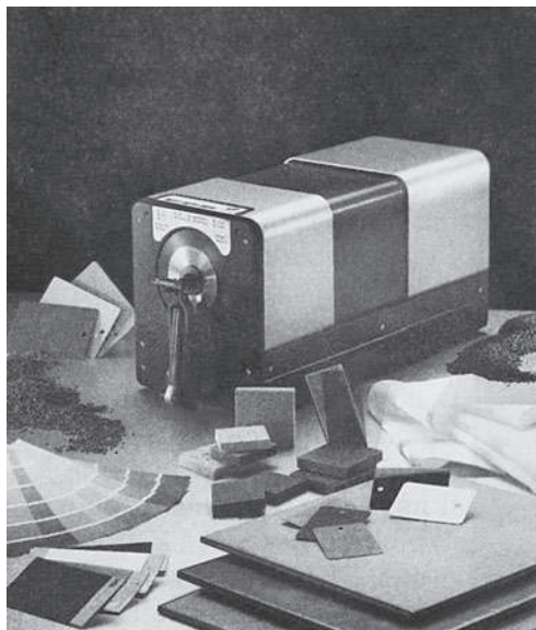
Рис. 6.12. Спектрофотометр (с разрешения Gretag Macbeth )
