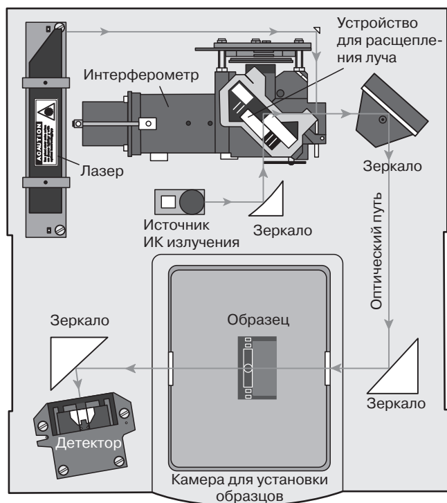
Рис. 7.24. Принципиальная схема инфракрасного спектрометра (с разрешения Nicolet Instruments )
