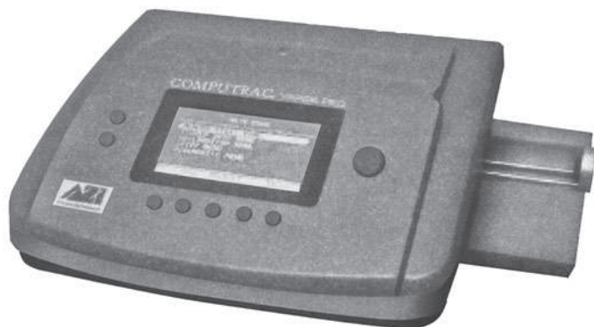
Рис. 10.4. Прибор сенсорного типа для измерения влажности (с разрешения Arizona Instruments )
