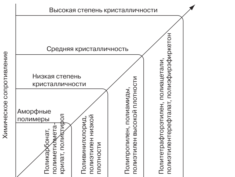
Рис. 15.8. Влияние кристалличности на сопротивление воздействию химических агентов
