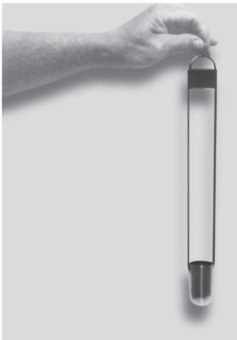
Рис. 12.6. Чашечный вискозиметр Zahn'a (с разрешения Byk-Gardner USA )
