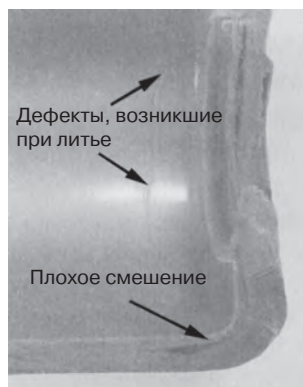
Рис. 15.20. Разрушение детали, обусловленное ошибками при осуществлении технологического процесса (с разрешения The Madison Group )
