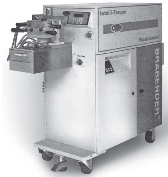
Рис. 12.3. Реометр Брабендера (с разрешения C.W. Brabender Instruments, Inc. )
