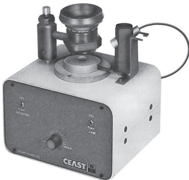
Рис. 13.2. Прибор для определения температуры плавления по методу Кюфлера (с разрешения CEAST USA)
