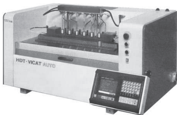
Рис. 3.1. Тестер для определения теплостойкости (с разрешения CEAST USA Inc.)
