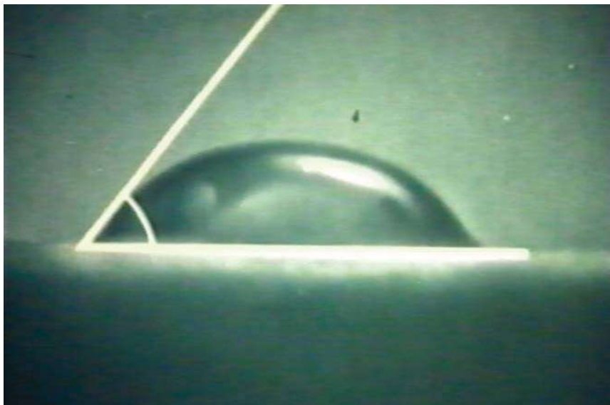
Явление смачивания – поверхность лиофильна (краевой угол \varphi < 90^\circ )
