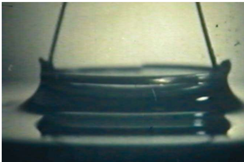
Определение поверхностного натяжения по методу отрыва кольца
