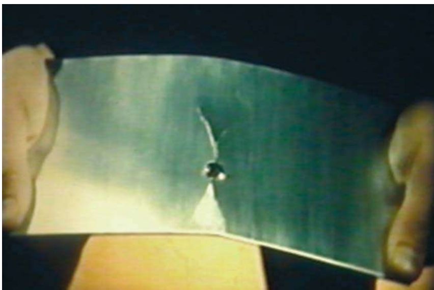
Под воздействием ртути пластинка легко ломается ( эффект Ребиндера )
