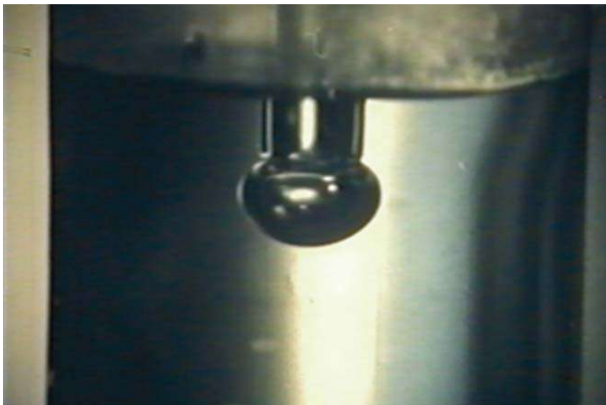
В момент отрыва пузырька давление равно капиллярному давлению \Delta P = \frac{2\sigma}{r}
