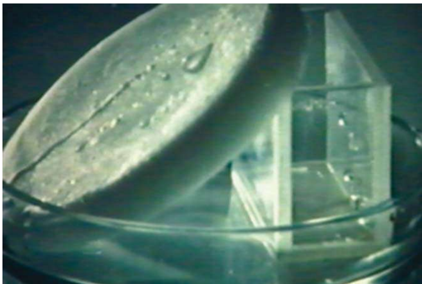
Нижняя часть парафина смачивается водой (после контакта с раствором ПАВ)
