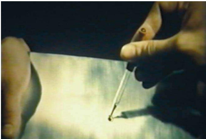
Ртуть – понижитель прочности для цинковой пластинки
