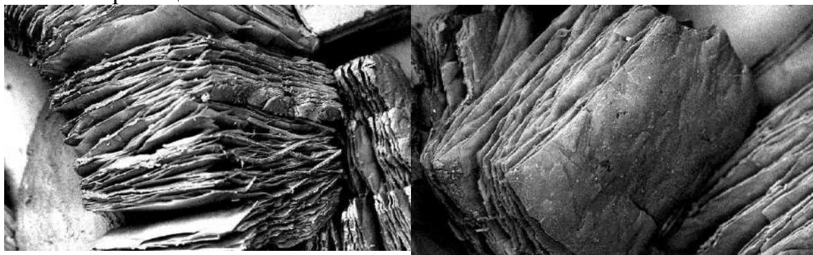
Рисунок 1 – Электронно-микроскопический снимок вермикулитового концентрата
