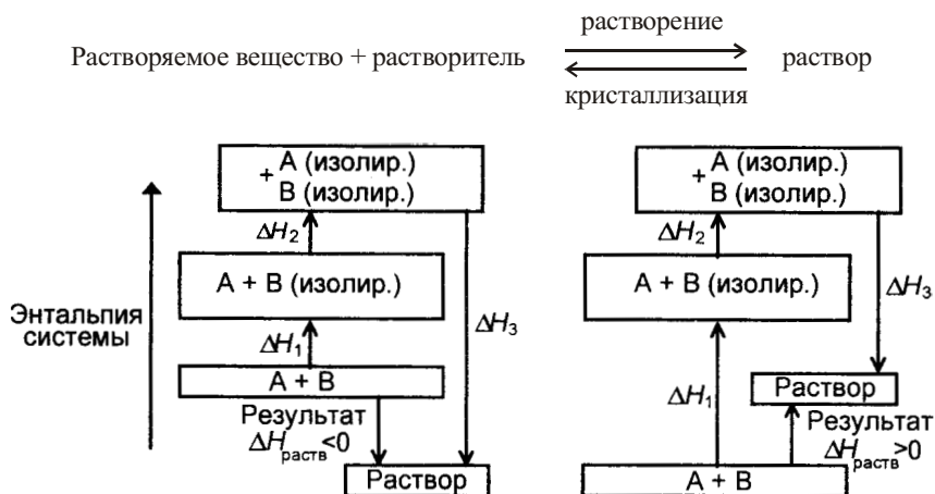
Рис. 35. Изменение энтальпии системы при экзотермическом и эндотермическом процессах растворения вещества В в растворителе А
