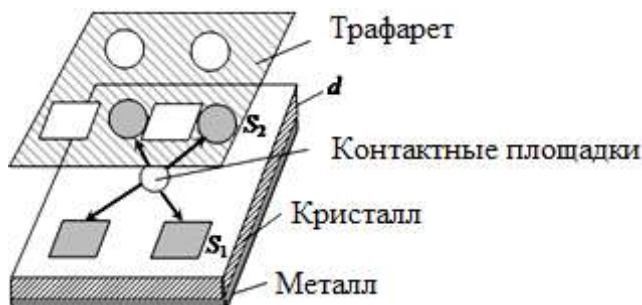
Рис. 4.9. Схема формирования контактных площадок с помощью трафарета
