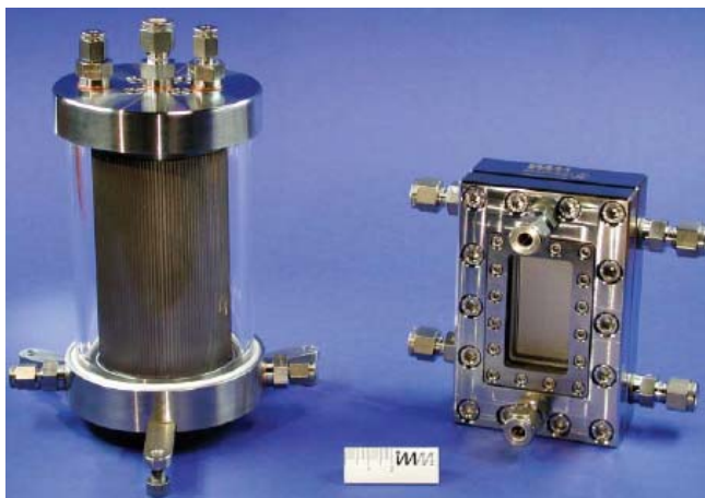
Рис. 12. Внешний вид цилиндрического микрореактора с падающей пленкой и его стандартной версии
