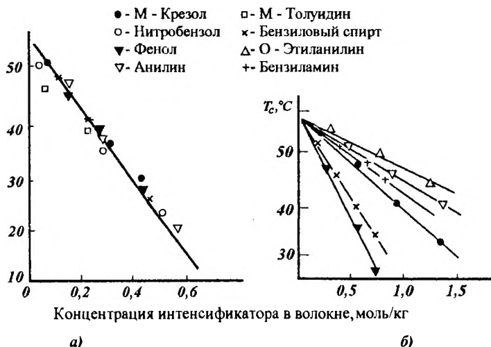
Рис. 3.30. Влияние интенсификаторов на температуру стеклования полиэфирных (а) и полиакрилонитрильных (б) волокон
