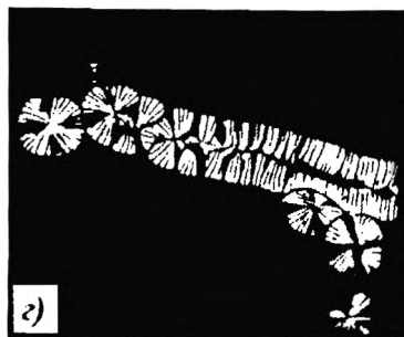
Рис. 3.16. Надмолекулярные образования в кристаллических полимерах:
