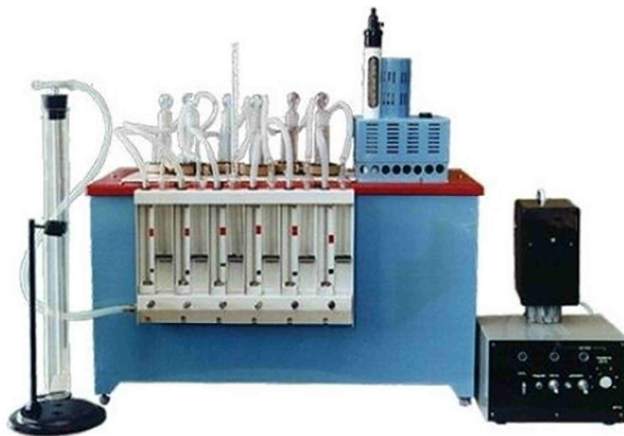
Рисунок 4.2 – Внешний вид аппарата АПСМ-1
