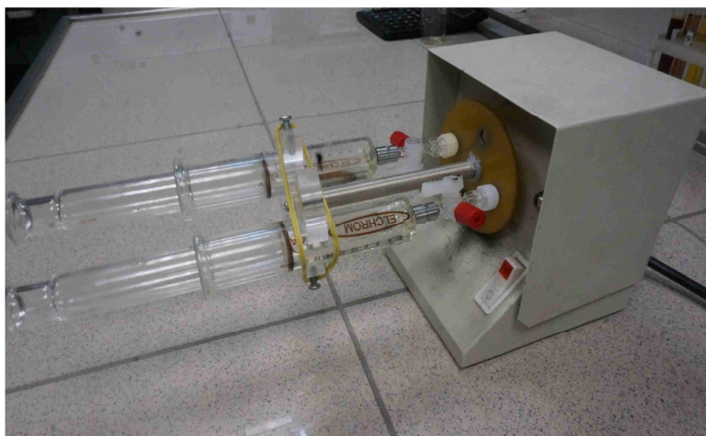
Рисунок 3.1 – Внешний вид устройства УДР для достижения равновесия с установленными пробоотборниками
