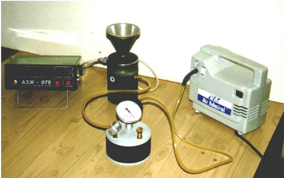
Рисунок 2.9 – Измеритель частиц загрязнения АЗЖ-975 в комплекте с вакуумным насосом и ресивером
