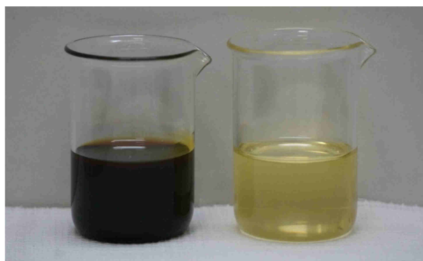
Рисунок 4.1 – Внешний вид рапсового масла, окисленного в жёстких условиях (слева) и этого же масла до окисления (справа)
