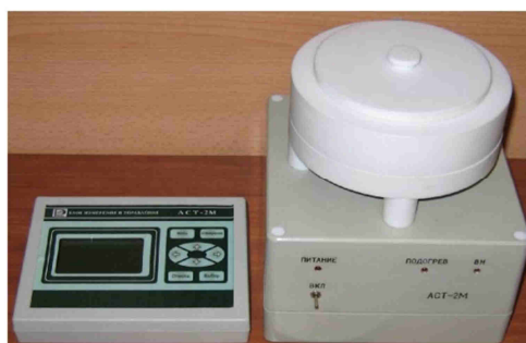
Рисунок 2.5 – Автоматический комплекс АСТ-2М для измерения tg \delta масел
