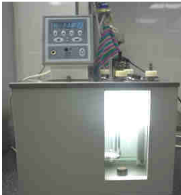
Рисунок 2.4 – Крио-термостат «КРИО-ВИС-Т-06-01» с установленным вискозиметром
