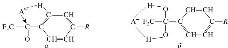
Рис. 1.61. Образование водородной связи (а); хелатный комплекс, образованный за счет водородной связи между кислородом аниона и водородом гем -диольной (гидратной) формы R -ТФАФ (б)
