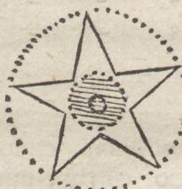
Гилза или бумажной корпусъ для пятилистной звѣздки калибромъ дѣлается отъ 8. до 16. лотковъ. Толстота спѣнки у гилзы на  $\frac{1}{3}$  и  $\frac{1}{6}$  часть калибра; длина гилзы 5 калибровъ.
