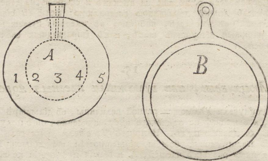
прорѣзать въ срединѣ круглую дыру , коей діаметръ долженъ быть въ 2. дюйма: для оной изготовить деревянную трубку , длиною въ 1½. дюйма; насквозь трубки въ срединѣ сдѣлать для состава дыру , шириною противъ гусинаго пера.
