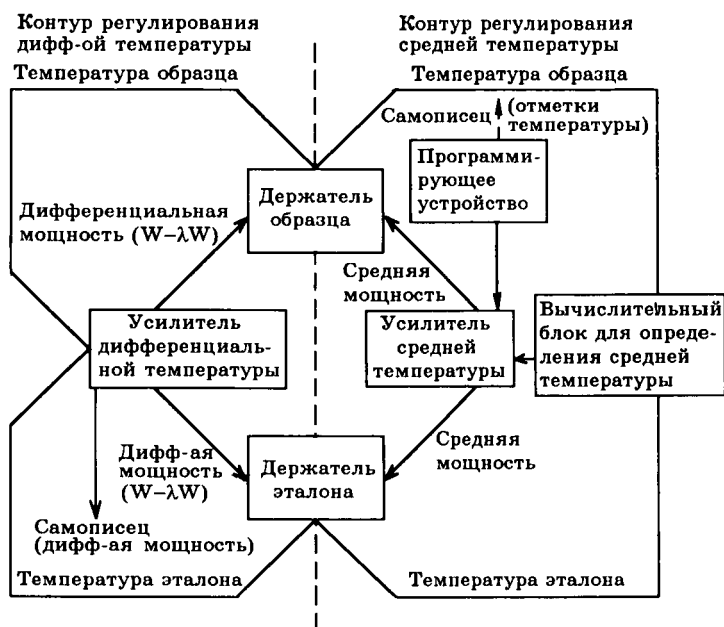
Рис. 9.2. Схематическая диаграмма прибора ДСК фирмы «Перкин-Элмер»
