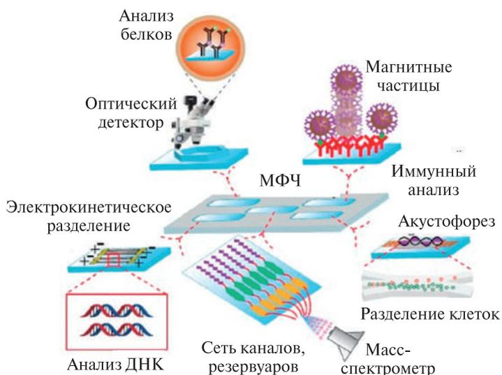
Рис. 74. Схема микрофлюидного чипа микрометров
