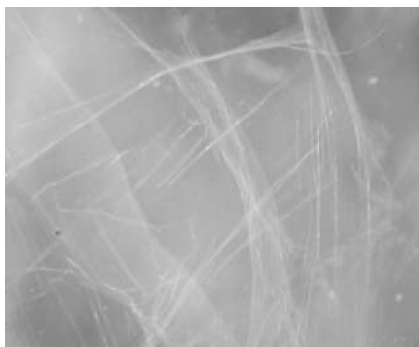
Рис. 1.8. Изображение полиэлектролитного комплекса, полученного при смешивании катионного и анионного сополимеров акриламида в водном растворе
