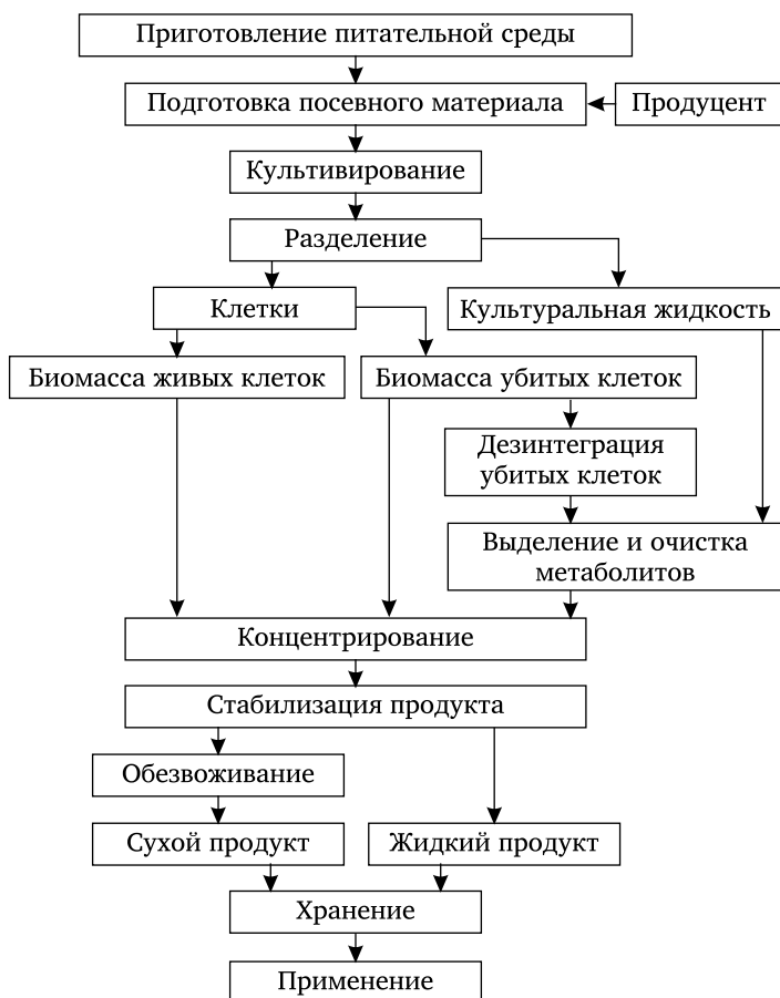
Рис. 9. Принципиальная биотехнологическая схема производства продуктов микробного синтеза
