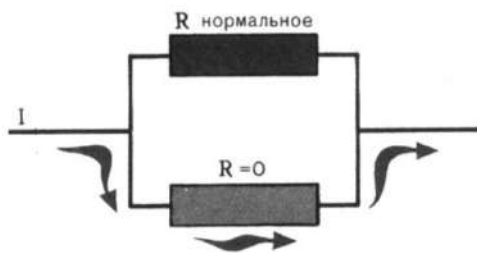
Рис. 7.7. Эквивалентная электрическая схема нормальной и сверхпроводящей электронных жидкостей
