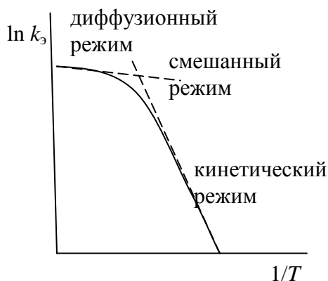
Рис. 2.11. Температурная зависимость скорости гетерогенной реакции в аррениусовских координатах
