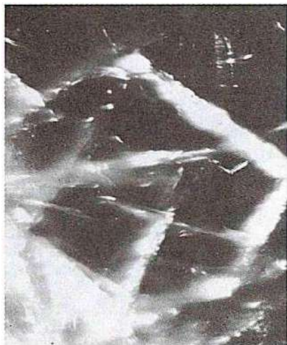
Рис. 57. Микрофотографии частиц \gamma -FeOOH, полученные на просвечивающем электронном микроскопе в режимах светлого (а) и темного (б) полей
