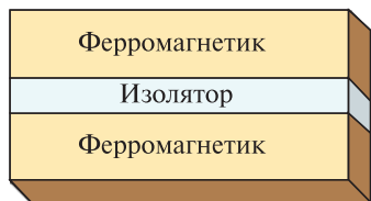
Рис. 11.13. Схема спинового клапана на основе использования явления магнитного туннельного перехода (Magnetic Tunnel Junction — MTJ)
