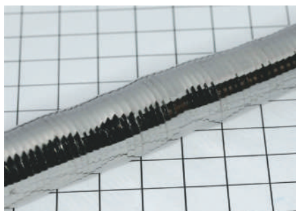
Рис. 8.7. Выращивание монокристаллов по методу зонной плавки: а — схема установки: 1 — подача аргона; 2 — кварцевый цилиндр; 3 — образец; 4 — выход аргона; б — внешний вид монокристалла
