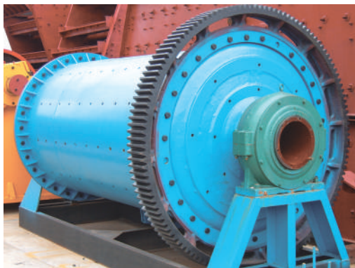
Рис. 3.2. Шаровая барабанная мельница
