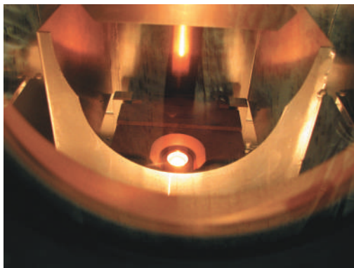
Рис. 9.3. Вид внутри камеры электронно-лучевого испарителя
