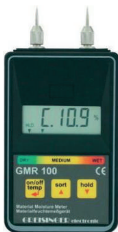
Рис. 2. Влагомер, основанный на кондуктометрическом методе измерения влажности
