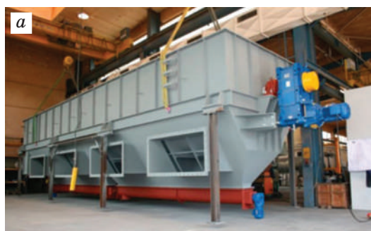
Рис. 98. Лопастная сушилка с перемешиваемым слоем материала:
