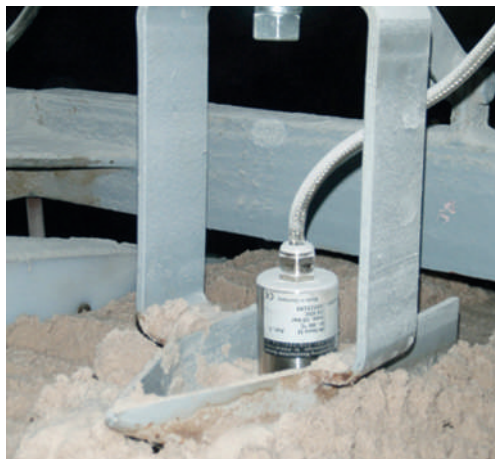
Рис. 3. Измерение влажности материала на транспортной ленте
