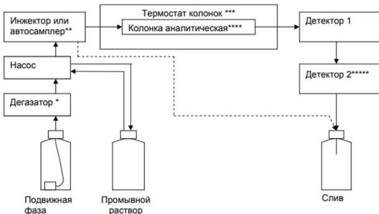
Рис. 44. Гидравлическая схема изократического хроматографа «Стайер»
